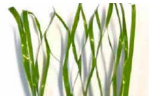
Gefibrilleerde vezel, een bandje dat in de fabriek wordt ingesneden (gefibrilleerd)
