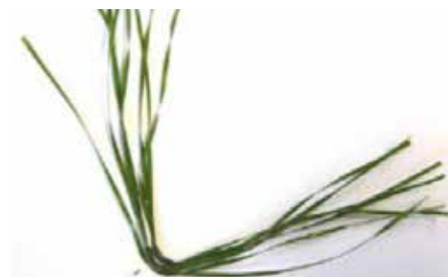
Monofilament, zes afzonderlijke mono filament garens in een bundeltje
